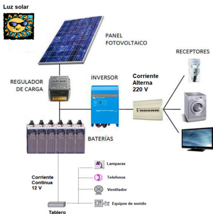
Figura 3. Componentes fotovoltaicos y distribución de energía eléctrica.
